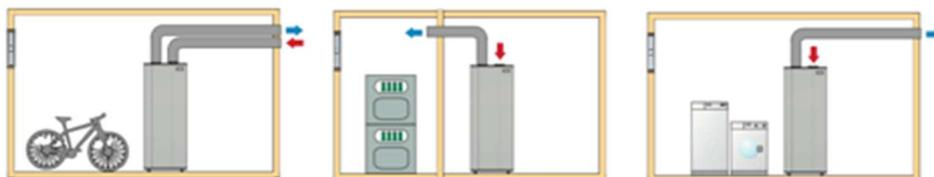
Poiché la temperatura dell'aria all'uscita è molto più bassa e secca di quella in ingresso, vi è la possibilità di utilizzare questo flusso d'aria per rinfrescare una stanza. In questo caso si raccomanda l'installazione di un doppio tubo, verso l'esterno e verso l'area da raffreddare, in modo che attraverso un serraggio l'utente può interrompere il flusso di aria fredda derivandolo all'esterno nei periodi in cui l'aria condizionata non è necessaria.
