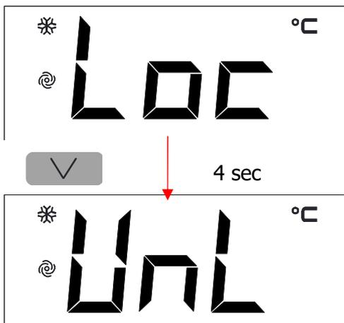
Trascorsi 30 s senza aver operato con i tasti il display visualizzerà la label “Loc” e la tastiera si bloccherà automaticamente.
