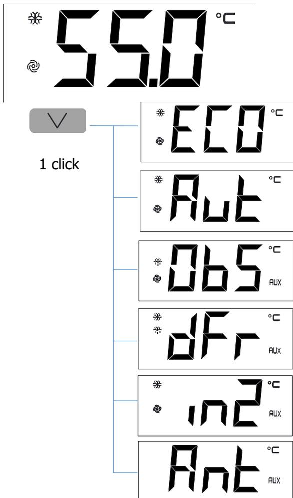
**Modalità ECO:** Riscaldamento dell’acqua con il solo utilizzo della pompa di calore
