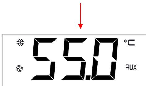
Il display visualizzerà la temperatura del tanque.
